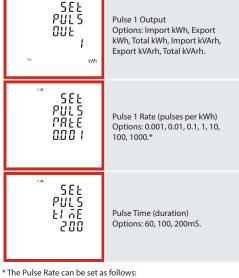
0.001 = 1 pulse per 1 Wh/VArh (1000 pulses per kWh/kVArh) = 1 pulse per 10 Wh/VArh (100 pulses per kWh/kVArh)
